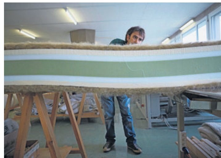
Un matelas presque terminé. Les ressorts sont enfermés dans la mousse et le tout est recouvert de laine, puis de tissu.
